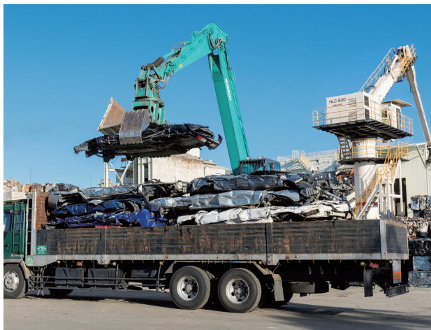
廃車ガラを回収、破碎して素材別に選別
