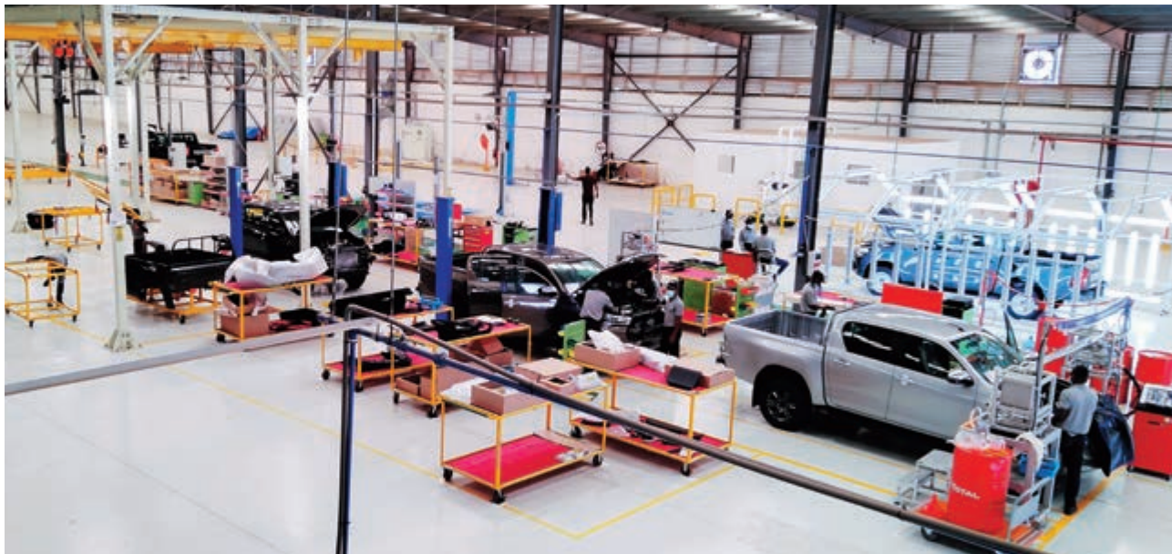
TOYOTA TSUSHO MANUFACTURING GHANA 「ハイラックス」の組立生産ライン
