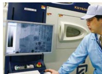
電子基板の検査
