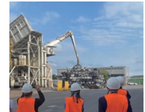
豊田メタル(株)サイトツアーでの様子 (廃車のプレシュレッダー投入の様子)
